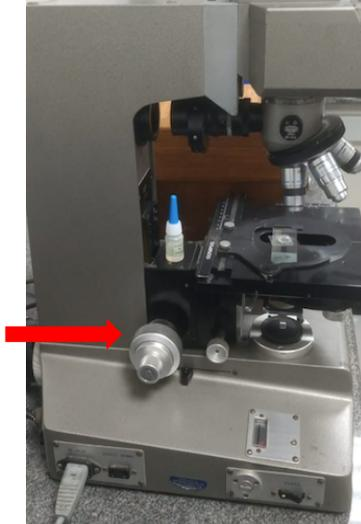
5. Uma vez realizado o ajuste grosseiro do foco, utilize o parafuso micrométrico (figura abaixo) para o ajuste fino do foco.
