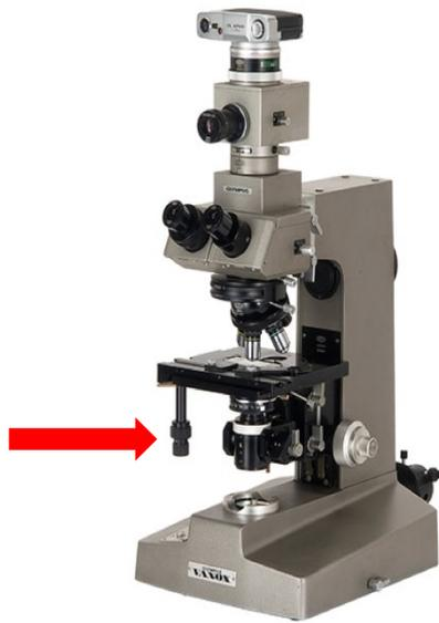
7. Para aumentar a imagem, utilize o canhão para trocar a objetiva (figura abaixo), indo da menor objetiva para a maior. Coloque na nova objetiva e foque a imagem novamente, utilizando somente o parafuso micrométrico. Repetir essa operação toda vez que alterar a objetiva.
