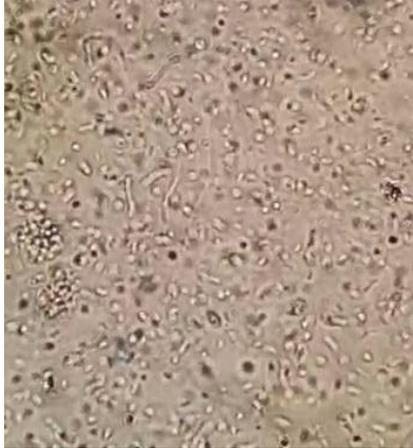
Figura 7 - Microscopia óptica com aumento de 1000x. Células livres devido a não formação de floco pela ação de grandes concentrações do íon  $\text{Na}^+$ . Formações de células livres não apresentam peso para decantar acarretando o arraste de sólidos no decantador secundário e ineficiência do processo de tratamento.
