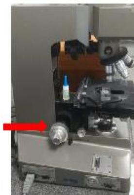
2. Uma vez realizado o ajuste grosseiro do foco, utilize o parafuso micrométrico (figura abaixo) para o ajuste fino do foco.
