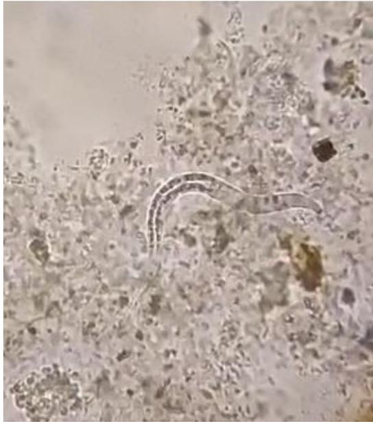
Figura 9 - Microscopia óptica com aumento de 400X. Nematóide perfurando floco biológico para se alimentar, a presença de organismos pluricelulares indica bom estado depurativo do processo, baixa toxicidade e idade de lodo avançada.
