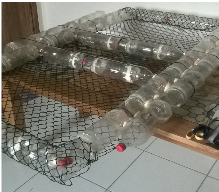
Figura 5 - Estrutura de uma ilha flutuante com a tela instalada.
